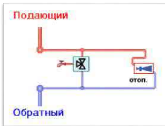
Рисунок 7.1. - Схема 26. Местный тепловой пункт с открытым водоразбором и циркуляционной линией.
