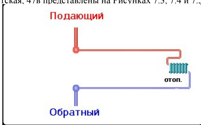
Рисунок 7.3. Местный тепловой пункт с открытым водоразбором.
